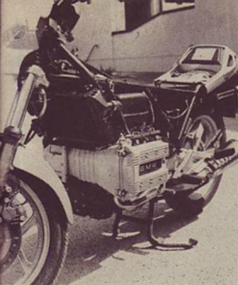
Trivaljniak je vpet v enostavno zasnovan, a kvaliteten cevni, spodaj odprt okvir, ki ga v nosilnosti dopolnjuje motor
